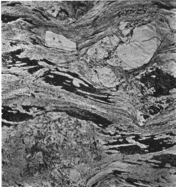
Fig. 2. Gepresster Porphyr, erste Stufe, mit sekundärer Fluidalstruktur. Vergr. 24 \times .
