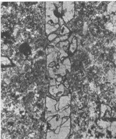
Fig. 6. Idiomorpher Olivin mit schlauchartigen Korrosionskanälen. Vergr. 50 ×.
