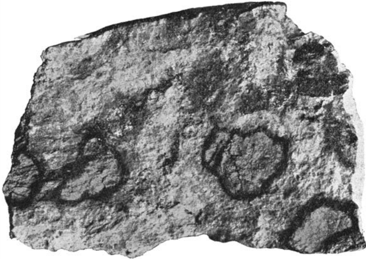
Fig. 2. Einschlüsse von Kupferglanz in Porphyr. (Nat. Gr.)
