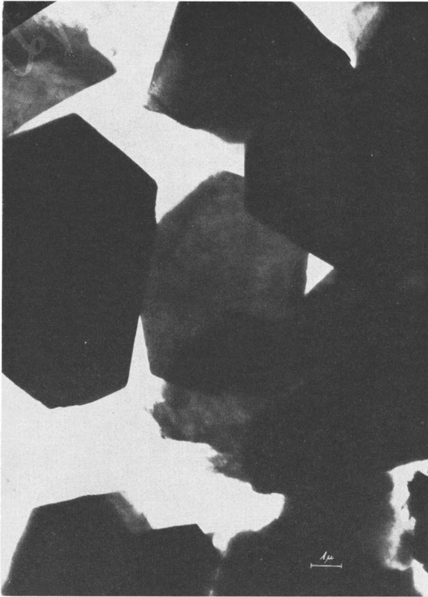
Abb. 6. Elektronenmikroskopische Aufnahme von Dickitkristallen ( 2-6 \mu ).
