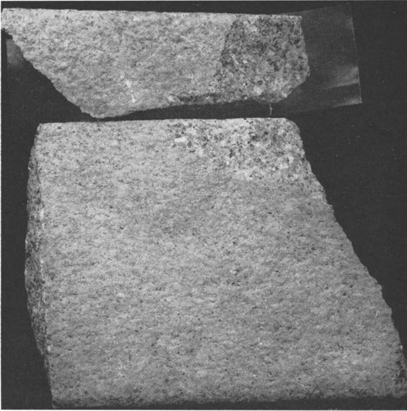
Abb. 3. Angewitterte, sandgeblasene Oberflächen (die Handstücke sind auch in Abb. 1 abgebildet; Probe N 3 ). Photo G. Andersson.
